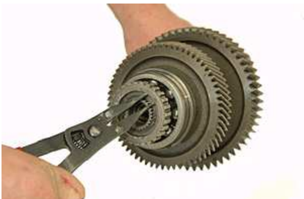
Step 21: アウトプットギアの端にあるスナップリングを取り外す。
