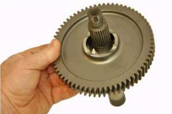
Step 37: キットに付属の新しいロースピードギアをアウトプットシャフトに組み付けます。
