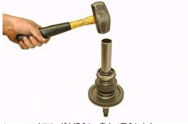
Step 50: ベアリングを挿入し、奥まで圧入します。
