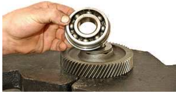
Step 24: ベアリングを取り外す。
