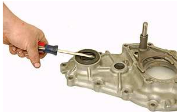
Step 68: センターハウジングからインプットシャフトシールを取り外します。
