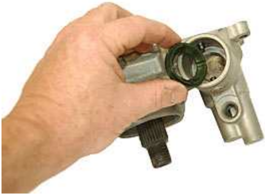
Step 65: ひび割れや欠損がないか注意して観察し、劣化や損傷の傾向が少しでも見られたら新品に交換しておきます。
