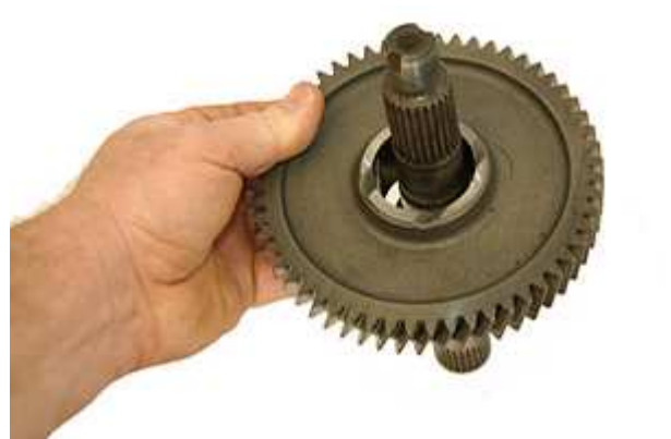
Step 34: ロースピードギアを取り外す。
