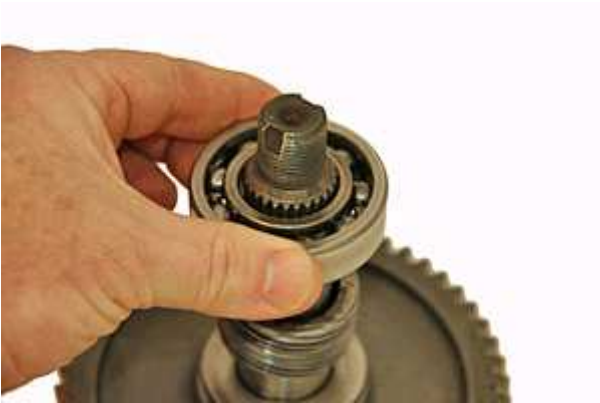
Step 31: ベアリングを取り外す。
