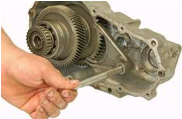
Step 19: 写真のように、シフトフォークを取り外す。
