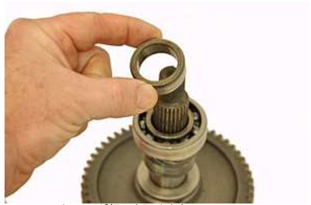
Step 30: ベアリング押えを取り外す。
