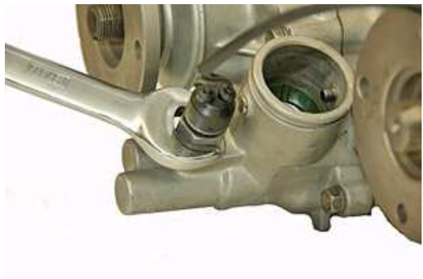
Step 106: 4wdインジケータスイッチを写真のように取付けて、完成です。
