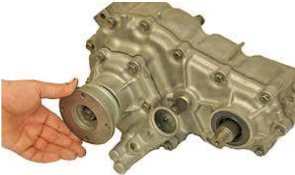
Step 97: フロントアウトプットフランジを取付け、フランジナットを適切な締め付けで固定します。
