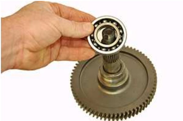
Step 41: ベアリングをアウトプットシャフトに挿入します。
