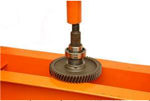
Step 29: ギアアセンブリをひっくり返し、今度はロースピードギアが抜き取れるようにシャフトをプレスする。
