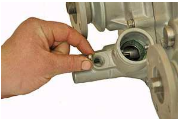
Step 105: step #3で取り外した、4wdインジケータのボールを元通りに組み込みます。
