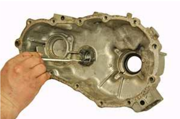
Step 87: リアハウジングとカウンターシャフトシムの当り面にグリスを塗布します。
