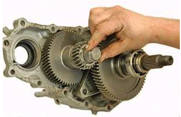
Step 84: 写真のように、ベアリングスペーサー(パイプ)を上から挿入します。
