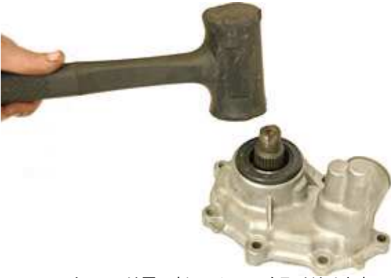
Step 71: キットに付属の新しいシールを取り付けます。
