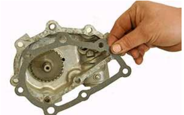
Step 94: 小さい方のペーパーガスケットの両面に液体シールを薄く塗布し、フロントハウジングの接合面に貼り付けます。
