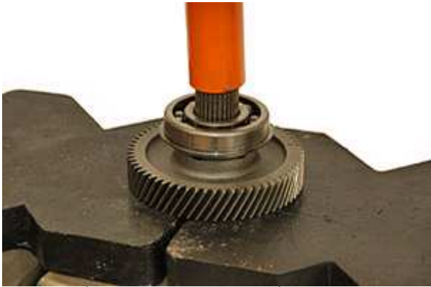
Step 23: プレスマシンを使い、アウトプットギアシャフトをベアリングが抜けるまでプレスする。
