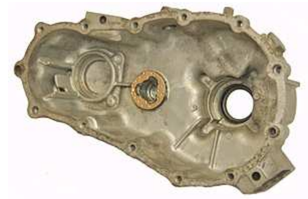
Step 88: もうひとつの新しいシムをリアハウジングの穴の上に載せます。シムにある耳をハウジング側の切れ込みに合わせるように注意してください。
