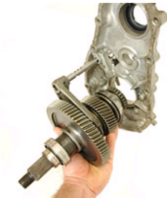
Step 75: アウトプットギアアッセンブリーをセンターハウジングへ挿入します。
