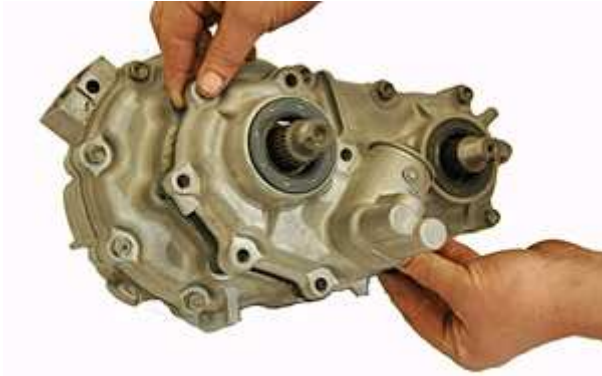
Step 95: 写真を参照して、フロントハウジングをセンターハウジングの全面にマウントしてください。
