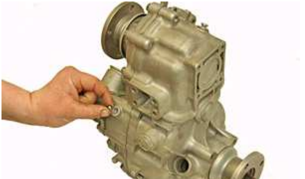
Step 100: 写真のようにトランスファーケースを立てておき、Step #7で取り外したディテントボールを穴へ落とし込みます。
