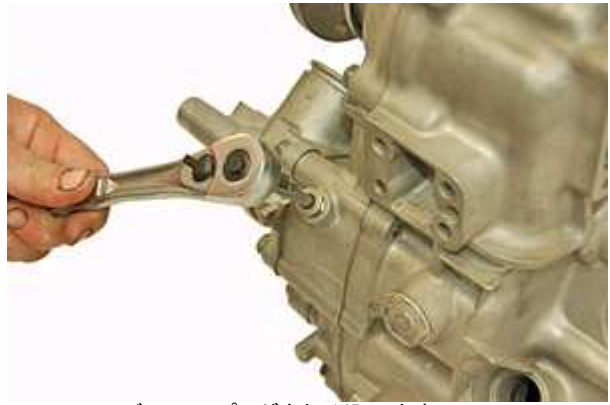
Step 102: ディテントプラグをねじ込みます。
