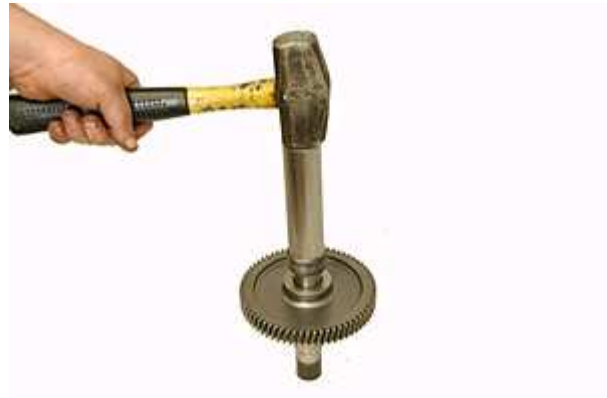
Step 40: 適当なパイプとハンマー又はプレスマシンを用いて、ドライブギアを奥まで圧入します。
