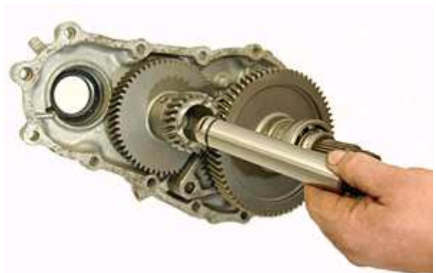
Step 82: 写真を参照し、カウンターシャフトをギアとシムに貫通させます。
