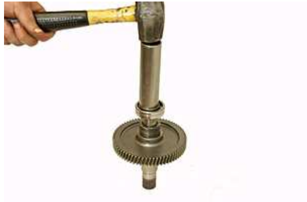
Step 42: ドライブギアと同様に圧入していきます。
