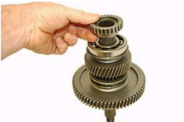
Step 51: 写真のとおり、小さいギアを元通りに組み付けます。
