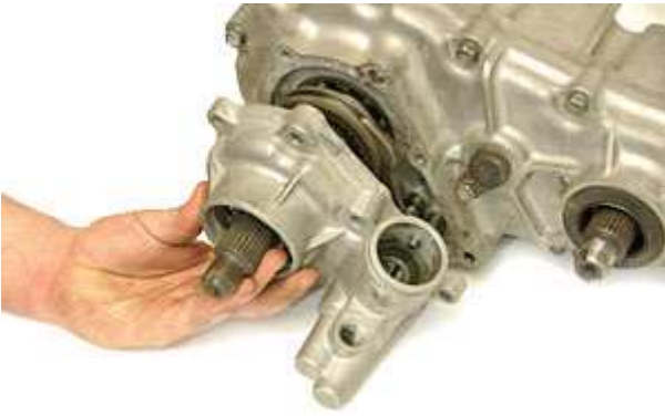
Step 11: フロントハウジングを分離します。
