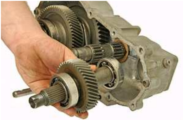
Step 17: インプットギアとベアリングアッセンブリーを取り外します。
