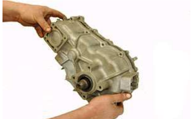
Step 90: リアハウジングを組み上げたセンターハウジングをカバーするように合わせます。ガスケットにダメージを与えないように注意し、カウンターシャフトはシムとホールの真ん中へフィットしていなければなりません。
