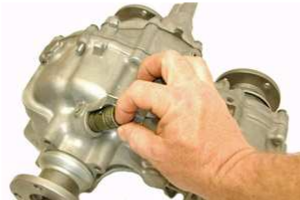
Step 103: スピードメータードライブユニットを元通りに取り付けます。
