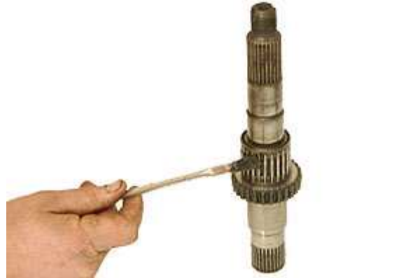
Step 36: アウトプットシャフトにニードルベアリングを再取付し、グリスを塗布しておきます。 ※ここではキットに付属のニードルベアリングは使いません。元ついていたベアリングが再使用できます。
