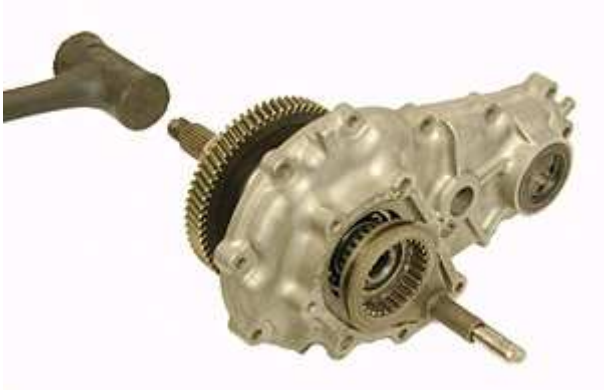
Step 77: アウトプットギアアッセンブリーが正しい位置に収まるように、シャフトをラバーハンマーでたたいてください。
