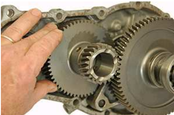
Step 81: 新しいカウンターシャフトギアを、シムがずれないように注意してセンターハウジングに付けたシムの上に置きます。
