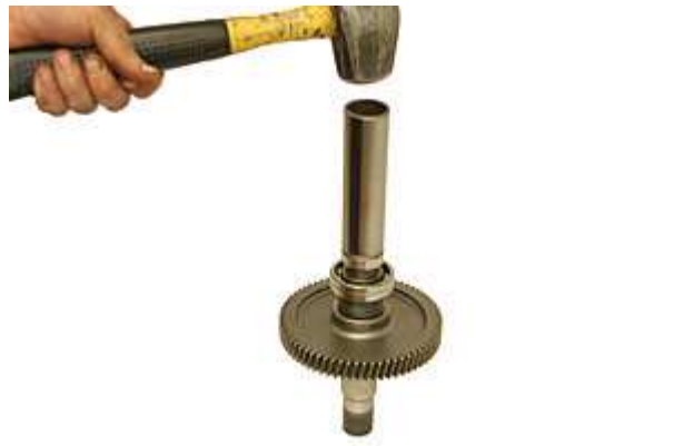
Step 44: 同様に適切な位置まで圧入する。
