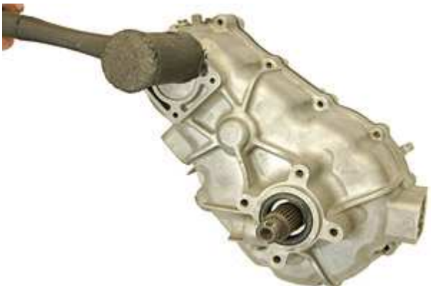
Step 91: センターハウジングとリアハウジングをお互いに密着させるよう、ラバーハンマーで軽くたたいて回ります。
