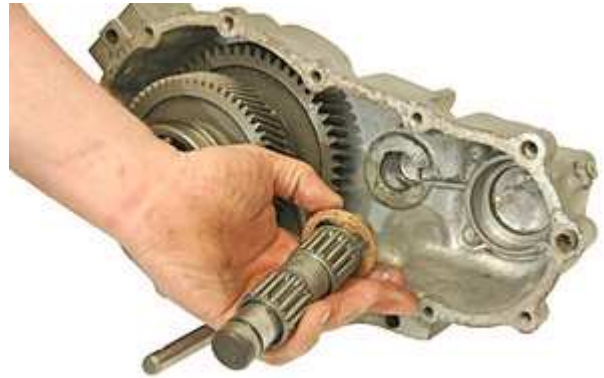
Step 18: ニードルベアリングがついたままカウンターシャフトとシムを取り外す。
