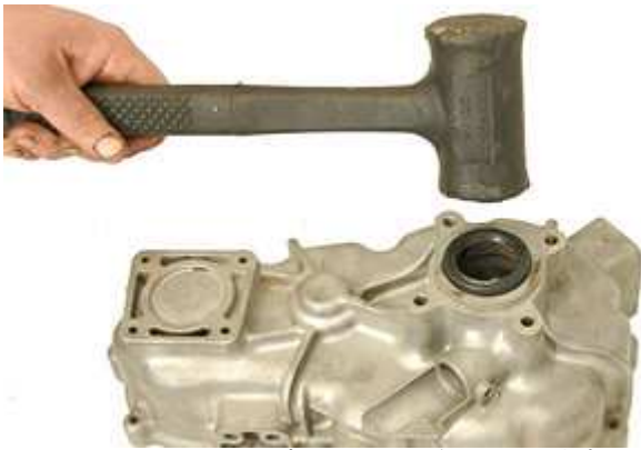
Step 67: キットに付属の新しいシールを取り付けます。
