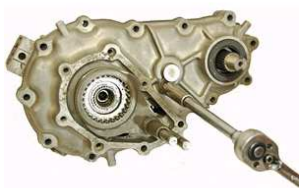
Step 92: カウンターシャフトの留め金がカウンターシャフトの溝に合うまでカウンターシャフトを回転させ（プライヤー等でシャフトをつまんで回せます）、留め金を取付けます。
