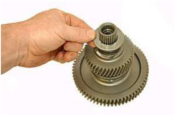
Step 49: シムスペーサーを挿入する。
