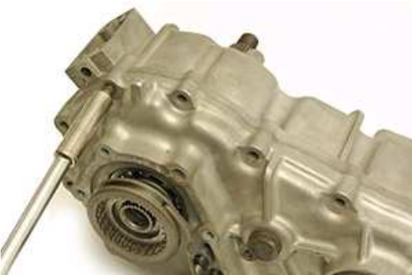
Step 13: リアハウジングとセンターハウジングを留めている11本のボルトを取り外す。ただし、11本のボルトは再組み付けの時に元の場所へ取り付けられなければならないため、位置がわかるようにマーキング等の処置をしておきます。
