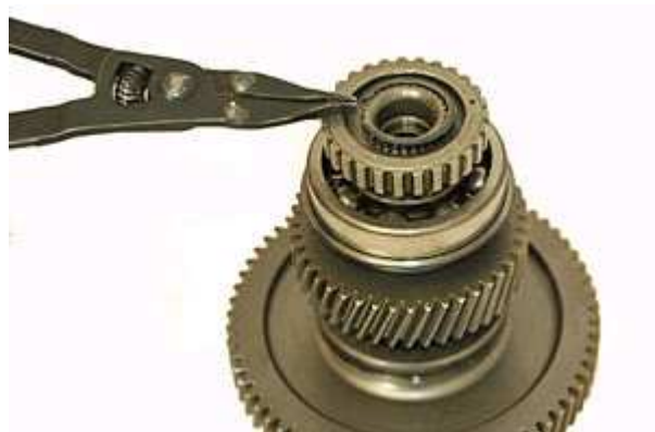
Step 52: 最後にスナップリングを取付けて、アウトプットギアアッセンブリーは完成です。
