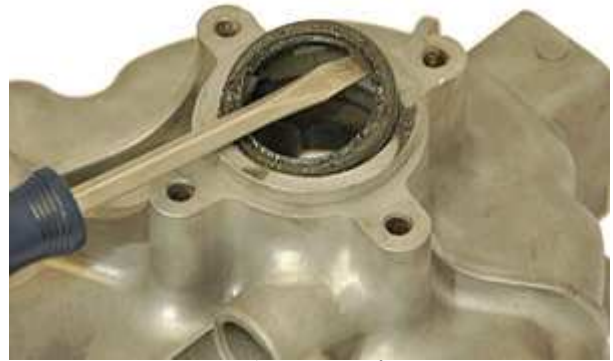
Step 66: リアハウジングからアウトプットシャフトシールを取り外します。
