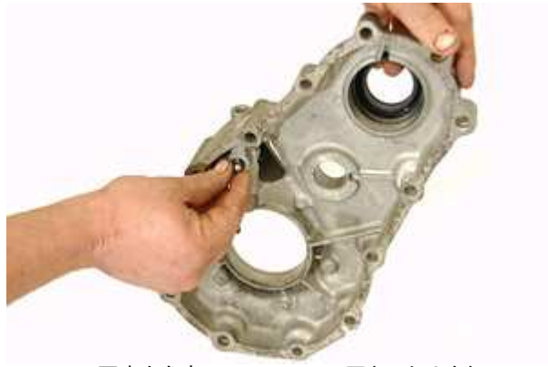
Step 72: 写真を参考に、Step #15で回収した小さなスチールボールをセンターハウジングに取り付けます。
