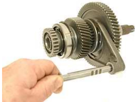
Step 74: high/low切替えシフトレールをアウトプットギアアッセンブリーのシフトフォークに差し込みます。
