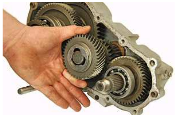
Step 16: リアハウジングから、カウンターシャフトギアとシムを抜き取ります。
