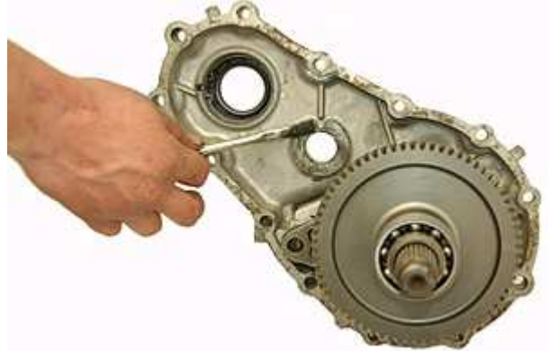
Step 78: センターハウジングとカウンターシャフトシムの当り面にグリースを塗布します。
