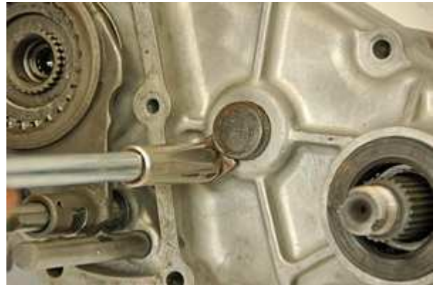
Step 12: カウンターシャフトを留めている留め金とボルトを取り外す。
