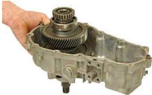
Step 20: リアハウジングからアウトプットギアアッセンブリーを抜き取ります。リアハウジングを裏返しにしてシャフト先端を木片等に当て、ハウジングを押し下げるとよいでしょう。外れにくい場合はハウジングを少し持ち上げ、シャフト先端がフラットに当たるように上から落してみてください。
