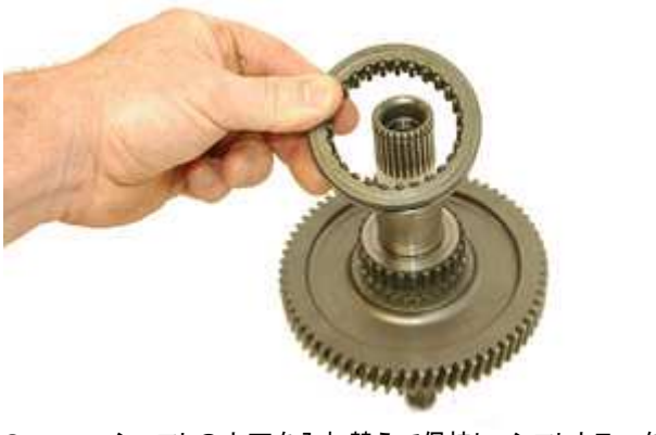
Step 45: シャフトの上下を入れ替えて保持し、シフトカラーを挿入します。
