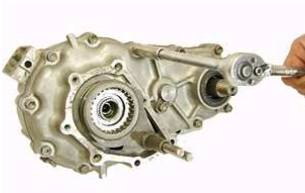
Step 93: センターハウジングとリアハウジングを接合している11本のボルトを取り付けます。ボルトのサイズはそれぞれ異なっているため、必ず元付いていた場所へ取付けてください。
