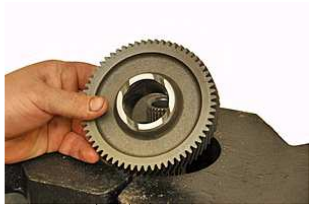
Step 25: ハイスピードギアを取り外す。
