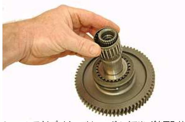
Step 46: アウトプットシャフトにニードルベアリングを再取付けします。 ※ここではキットに付属のニードルベアリングは使いません。元ついていたベアリングが再使用できます。
