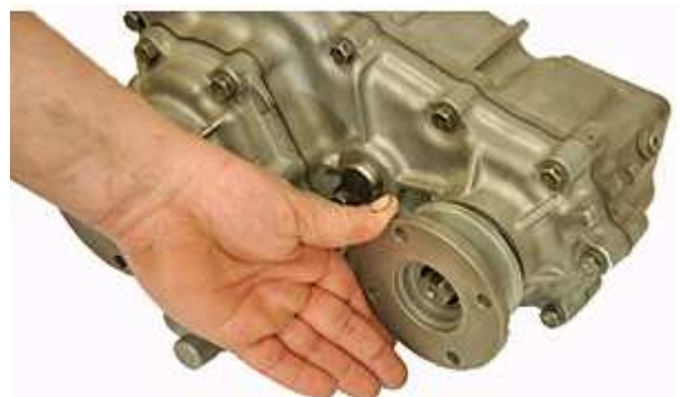
Step 98: インプットシャフトフランジを取付け、フランジナットを適切な締め付けで固定します。
