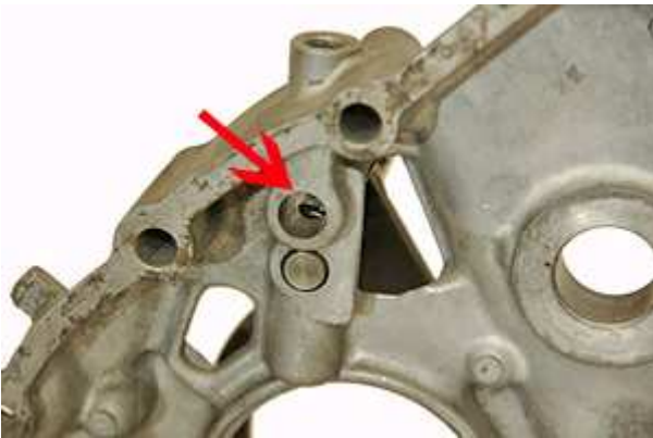
Step 73: ボールが見えなくなる程度まで穴の奥に落ち込むように、シフトレールを動かします。
