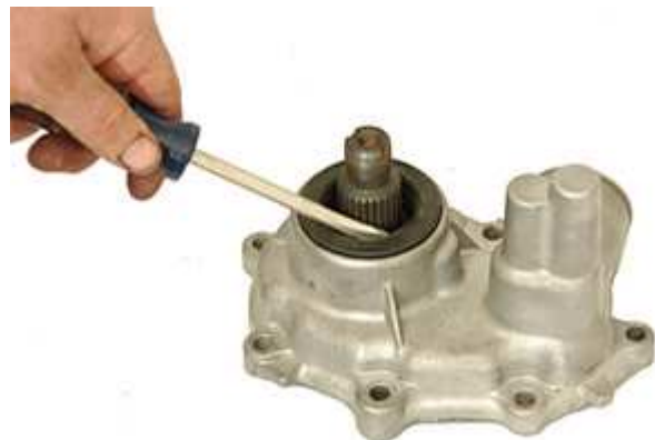
Step 70: フロントハウジングからフロントアウトプットシャフトシールを取り外します。
