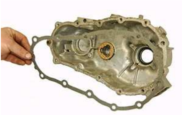
Step 89: 大きい方のペーパーガスケットの両面に液体シールを薄く塗布し、リアハウジングの接合面に貼り付けます。
