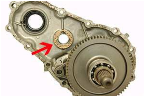
Step 79: キットに付属の新しいシムをグリースを塗布した面にあてがいます。シムにある耳をハウジング側の切れ込みに合わせるように注意してください。
