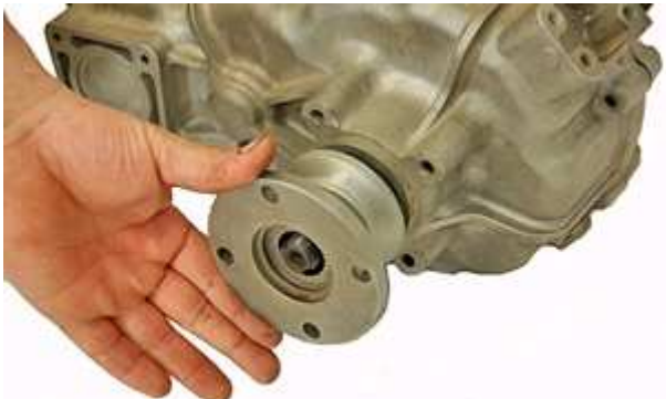
Step 99: リアアウトプットフランジを取付け、フランジナットを適切な締め付けで固定します。リアアウトプットフランジは他の2つのフランジより長く、異なりますので、間違えないように注意してください。
