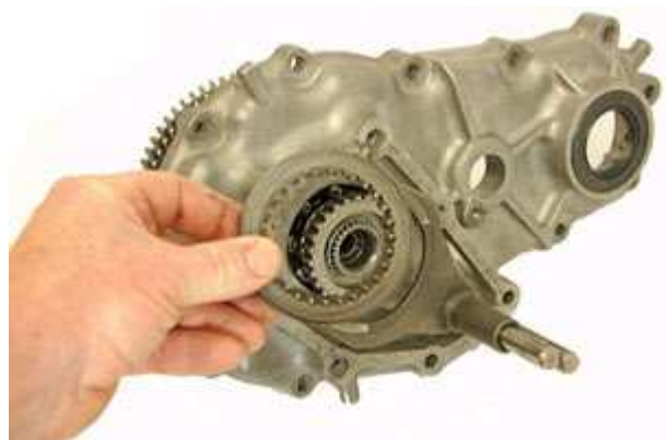
Step 76: フロントアウトプットシフトカラーをシフトフォークの外側へかぶせます。
