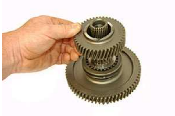
Step 48: キットに付属の新しいハイスピードギアをアウトプットシャフトに組み付けます。
