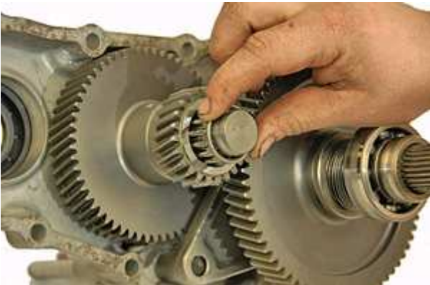
Step 85: 二つ目のニードルベアリングにグリスを塗布し、さらにカウンターシャフトとギアの間隙に挿入します。
