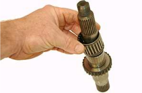
Step 35: ニードルベアリングを取り外し、ニードルベアリング、アウトプットシャフト、ハウジングをきれいに清掃、洗浄してください。
