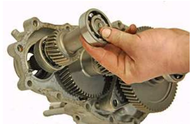
Step 86: 最後に組み上げたインプットギアアッセンブリをハウジングへ挿入してください。
