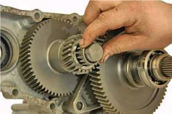
Step 83: カウンターシャフトに入れる新しいニードルベアリングにグリスを塗布し、カウンターシャフトとギアの間隙に挿入します。
