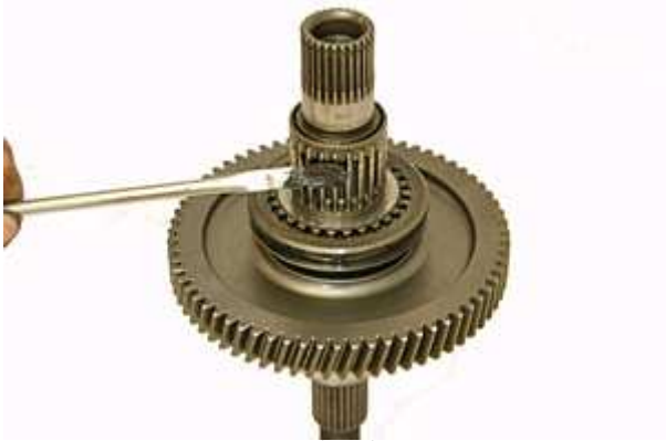
Step 47: ニードルベアリングにグリスを塗布します。
